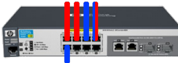
Ports en mode access (deux VLAN différents) et un port en mode trunk .
