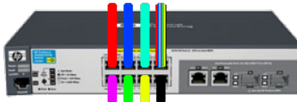
Ports en mode private VLAN et un port en mode trunk .
